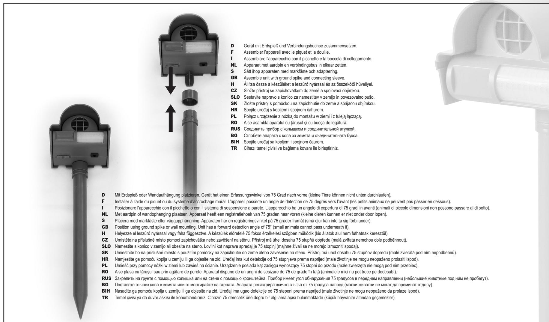
**D** Gerät mit Erdspieß und Verbindingsbuchse zusammensetzen.
